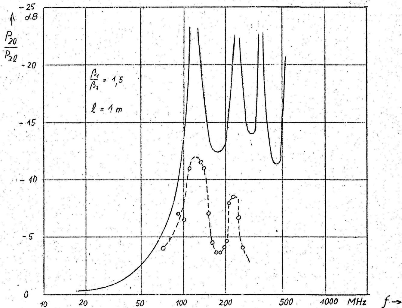
Bild 5 Verhältnis der am sendernahen Ende auftretenden Störleistung  $P_{20}$  zu der am senderfernen Ende auftretenden Störleistung  $P_{2l}$  in Abhängigkeit von der Frequenz.
