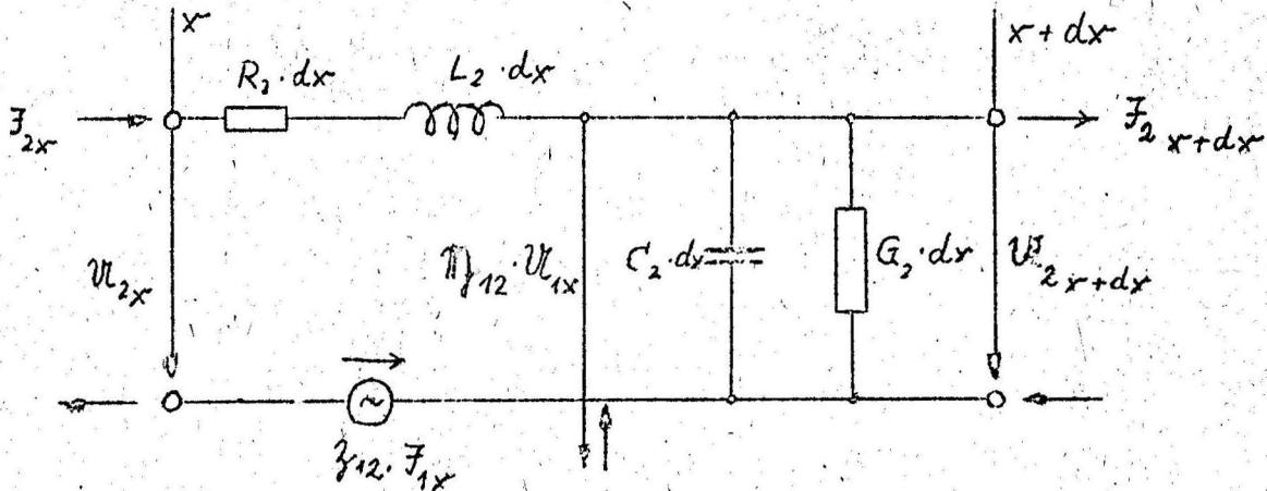
Bild 2 Elektrisches Ersatzbild eines Leitungselementes des äußeren Systems von Bild 1
