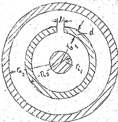
Bild 4 Längsschlitz (b, d) im Mantel eines Kabels ( $r_{a1}, r_{i1}$ ) des Innenleiters gegen die Außenhülle, die ein Maß für die elektrische Kopplung ist,
