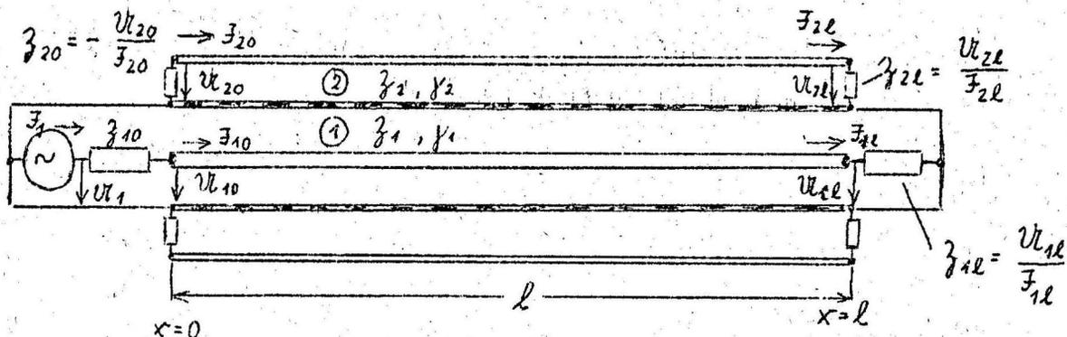
Bild 3 Allgemeinste Meßanordnung zur Bestimmung des Kopplungswiderstandes und des Kopplungsleitwertes
